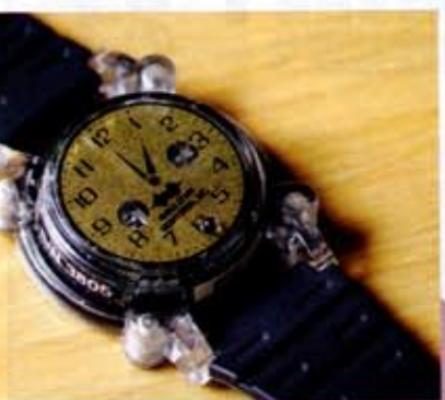
↑重さ約30グラムの軽量・小型のアクティグラフ。睡眠リズムの乱れや無呼吸睡眠症の診断に用いるほか、睡眠日記の補助的な役割としても活用されている
